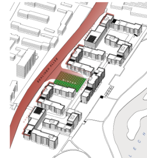
lärmgeschützte Bebauung entlang Berliner Allee
