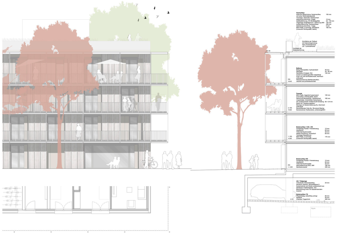
Baufeld 2+4 Detail Beispielschnitt mit Grundriss und Schnitt von Vier-Geschosser am Boulevard M: 1_50
